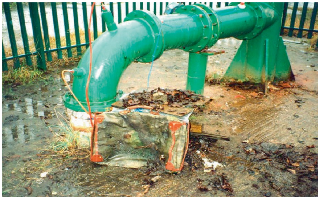
图 4.2 使用封装的便携式仪器在英国某废弃矿山的竖井通风口进行监测（前景图）
