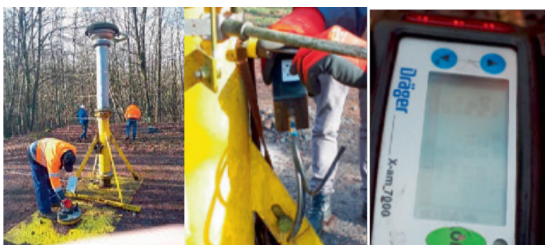
图 3.2 德国某废弃矿井的排气口测量
